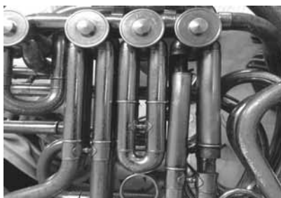
老朽化した楽器 (溶接の取れた管)
